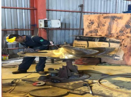
Gambar 3 15 Proses Pengerindaan Propeller
