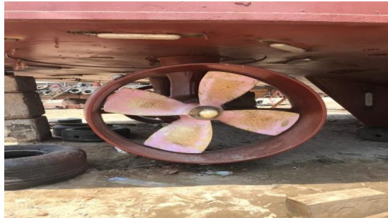
Gambar 3 17 Proses Pemasangan Propeller
