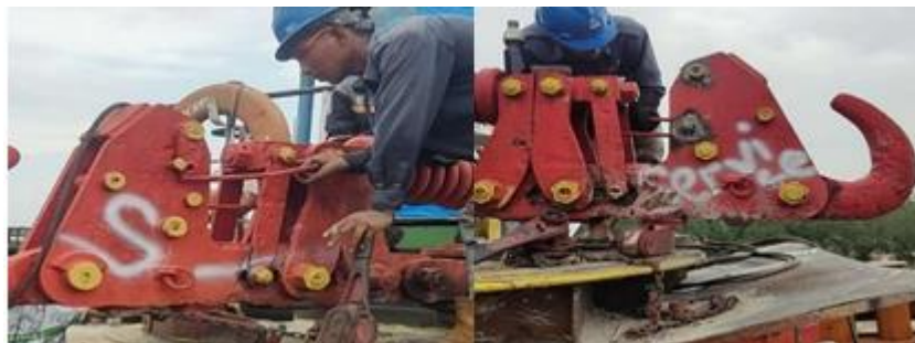
Gambar 2 55 Perbaikan Pada Towing Hook Kapal Tugboat,
