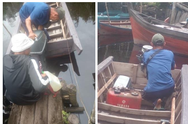
GAMBAR 4.9 Pemasangan dan Pengecekan Mesin Tempel
