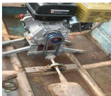
Gambar 4.35 Pemasangan Mesin dan Penyetelan Sabuk V-Belt pada Sistem Water Jet
