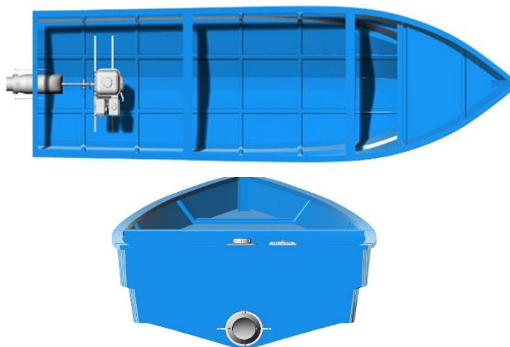
Gambar 4. 9 Desain penempatan sistem penngerak pada kapal
