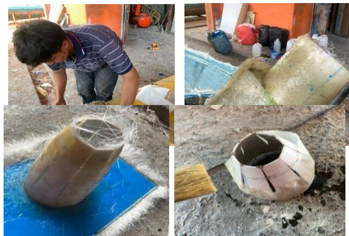
Gambar 4.17 Proses Laminasi Fiberglas , kontur intake , Nozle , dan system Manuver
