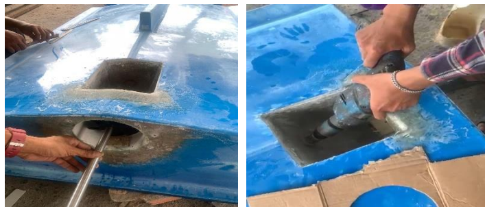
Gambar 4.23 Proses Marking dan Pengeboran Lubang Poros Impeller
