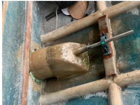
Gambar 4.25 Dudukan Bearing dan Besi Holo, Shaf Setelah Proses Laminasi
