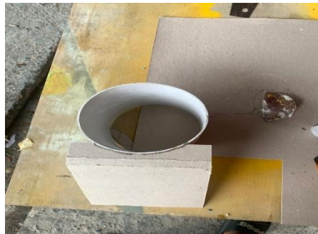
Gambar 4.11 Proses menyatukan karton dengan pipa PVC
