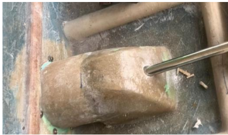
Gambar 4.24 Pemasangan Poros dan Dudukan Holo sebagai Penyalur Daya Impeller
