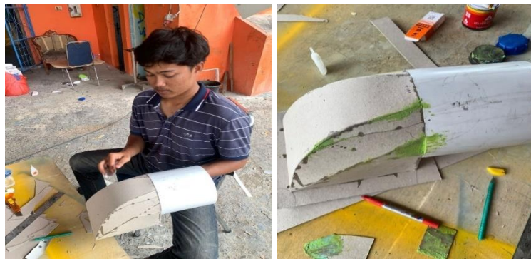
Gambar 4.14 Proses pendempulan cetakan
