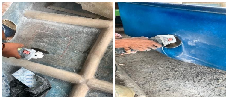
Gambar 4.20 Proses Pemotongan Lubang Intake dan Nozle
