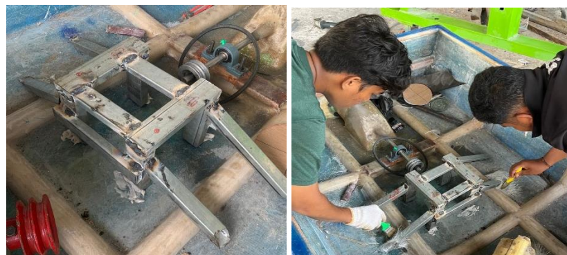
Gambar 4.31 Proses Fitting dan laminasi pada dudukan mesin
