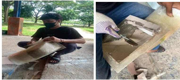
Gambar 4.18 Proses pelepasan cetakan dan pembersihan permukaan kasar
