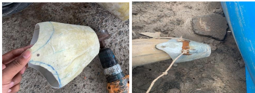
Gambar 4.36 Pemasangan Sistem Manuver pada Ujung Nozzle
