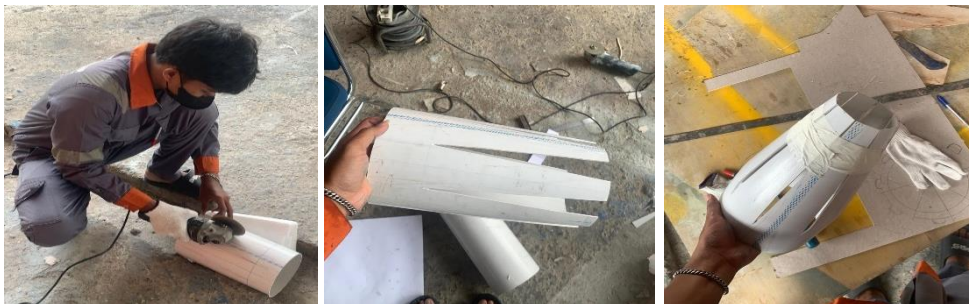
Gambar 4.16 Proses pemotongan dan pembentukan Nozle dan system Manuver
