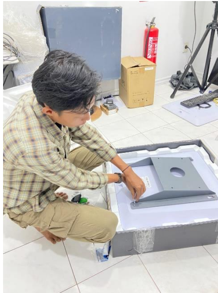
Gambar 3. 27 Proses Pemasangan Bracket Mounting pada Perangkat Starlink
