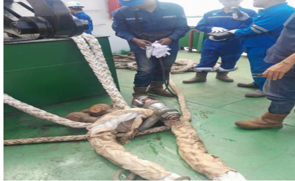
Gambar 3.35 mooring dan load cell
