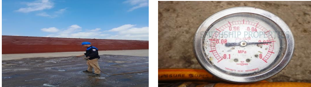
Gambar 3.31 Penyemprotan air sabun dan tekanan udara
