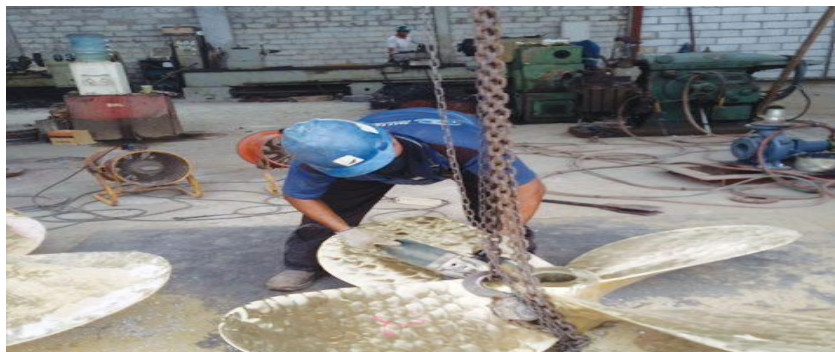
Gambar 2.9 Pembongkaran & Penyemenan Propeller Sumber: PT Dutabahari Menara Line Dock Yard
