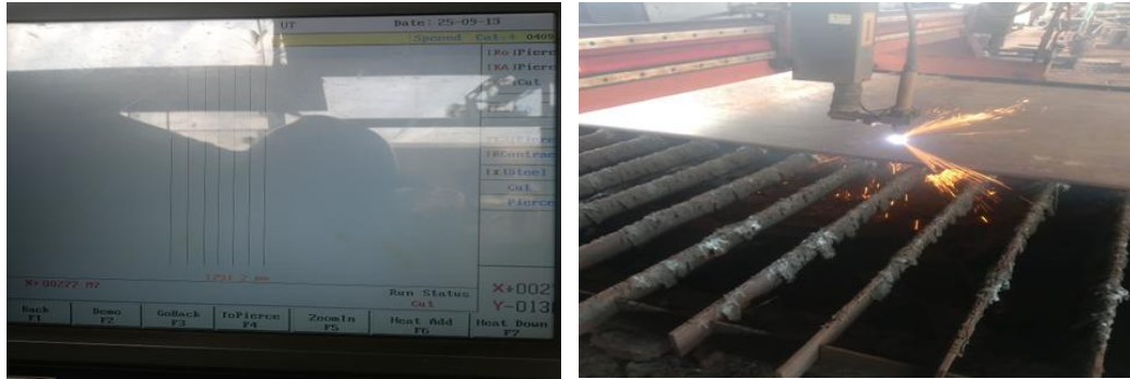
Gambar 3.47 Proses pemotongan Plat 10 2400x300mm
