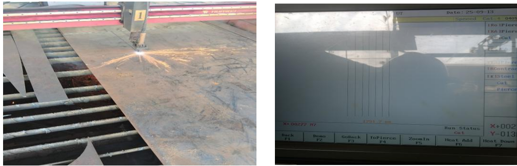
Gambar 3.53 Pemotongan profil T 300x2400mm
