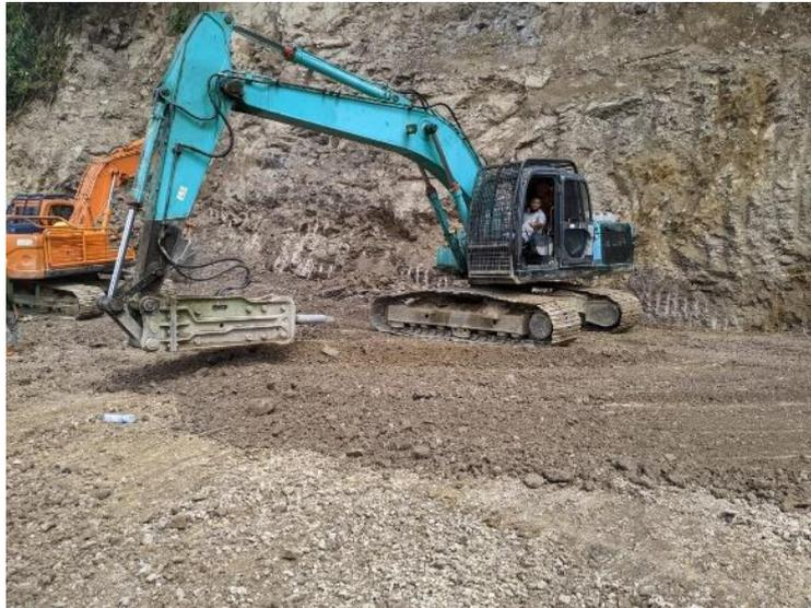
**Gambar 4. 6** Buchet excavator di ganti breker
