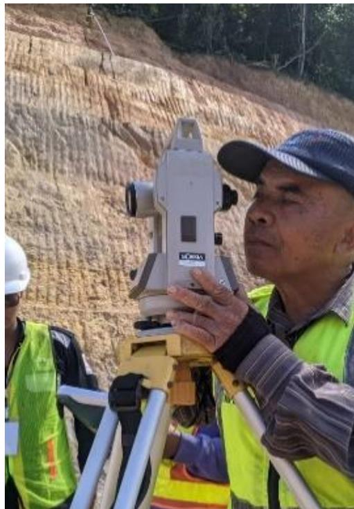
**Gambar 4. 19** Theodolite alat untuk mengukur elevasi
