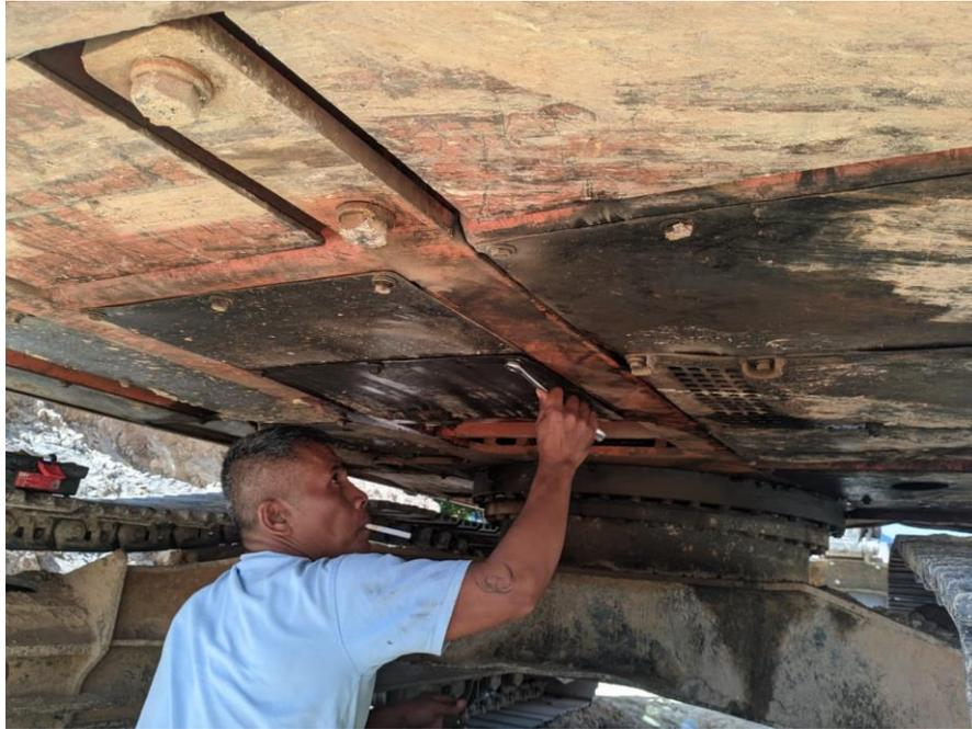
**Gambar 3. 3** Perawatan alat excavator dengan memberikan gomok atau minyak gris agar excavator terawat
