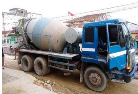
Gambar 3. 23 Truck Mixer (Sumber: Dokumentasi KP, 2024)
