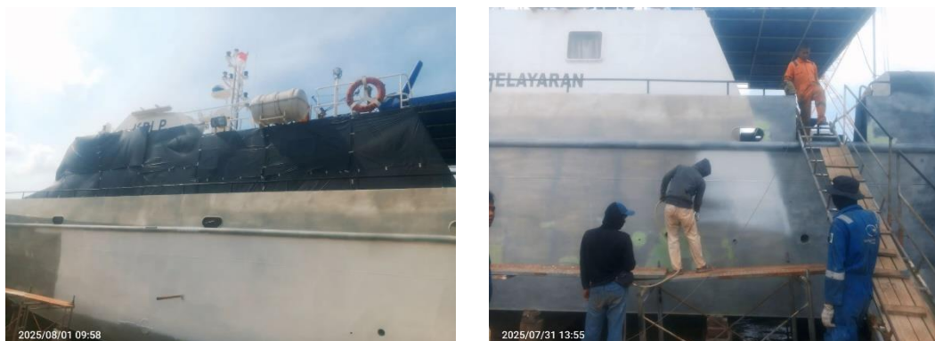
Gambar 3. 35 Deck house yang sudah di Masking dan pengecatan
