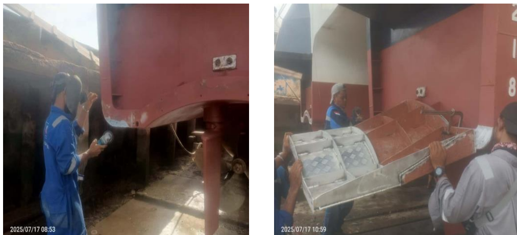
Gambar 3. 8 Proses pembuatan bevel dan fit up trim belakang
