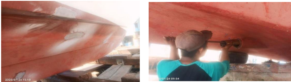
Gambar 3. 18 Penambalan lambung dan membuka ruber bearing
