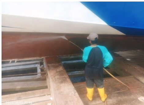
Gambar 3.47 Proses waterjet Dan valve yang sudah terlepas
