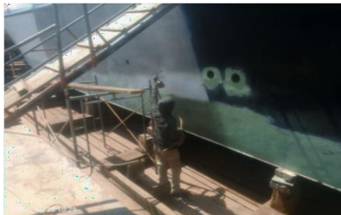
Gambar 3. 26 Proses Epoxy dan pembersihan frame grating plate
