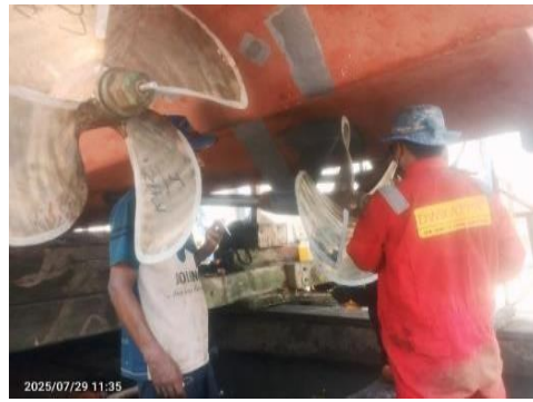
Gambar 3. 27 Proses pemasangan shaft dan propeller
