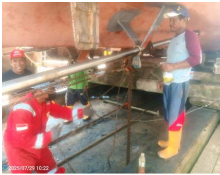
Gambar 3. 27 Proses pemasangan shaft dan propeller
