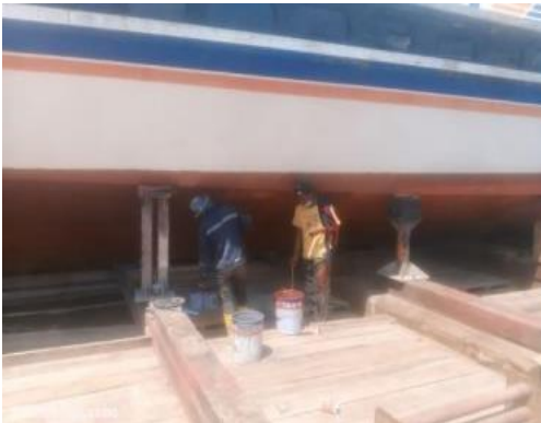
Gambar 3. 29 Proses Epoxy pada bagian yang sudah di sanding
