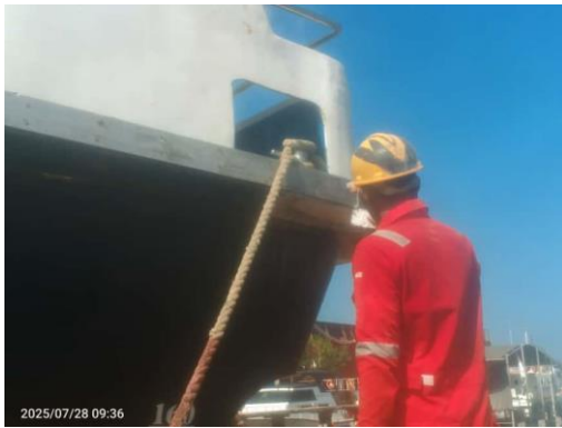
Gambar 3. 25 Pemasangan plat fender dan pengaplikasian gelcoat
