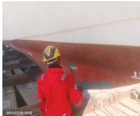
Gambar 3. 29 Proses Epoxy pada bagian yang sudah di sanding
