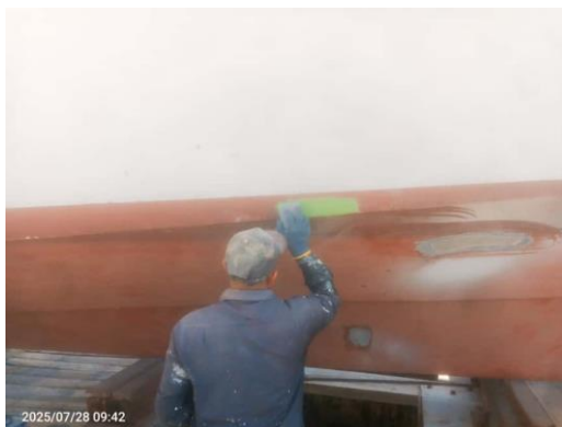
Gambar 3. 24 Proses pendempulan pada bagian yang sudah di laminasi
