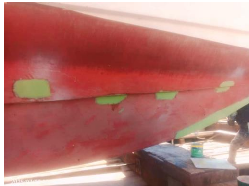
Gambar 3. 24 Proses pendempulan pada bagian yang sudah di laminasi
