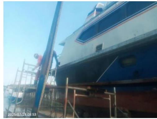
Gambar 3. 25 Pemasangan plat fender dan pengaplikasian gelcoat
