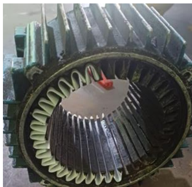
Gambar 3. 41 Pemasangan kertas pelindung email drad/ kertas nemox.
