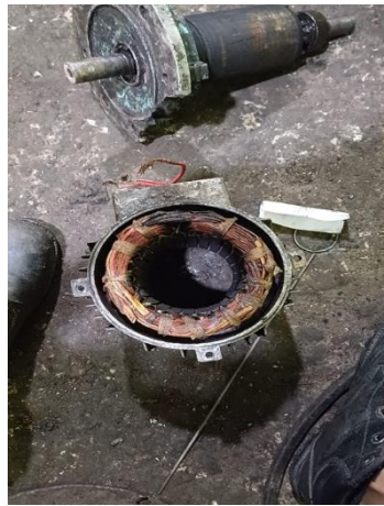
Gambar 3. 37 pembongkaran elmot yang terbakar.
