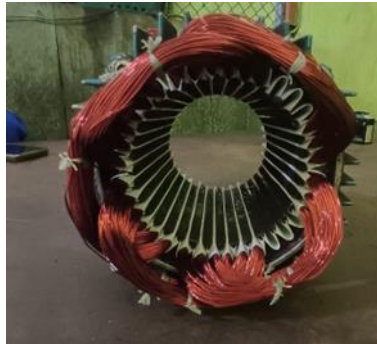
Gambar 3. 43 Pemasangan email drad pada stator.
