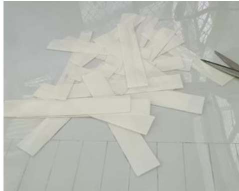
Gambar 3. 46 Pembuatan kertas pelindung email drad/ kertas nemox
