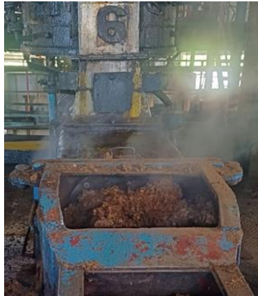
Gambar 3. 18 Pengambilan sampel presan (sumber:dokumentasi di PTPN IV sei buatan 2025)
