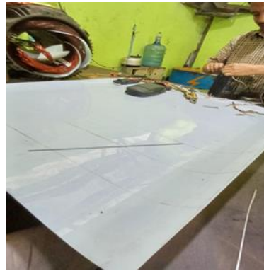
Gambar 3. 70 Pembuatan kertas pelindung email drad.
