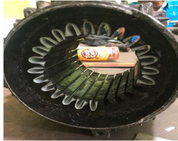
Gambar 3. 49 Pemasangan kertas pelindung email drad/ kertas nemox.
