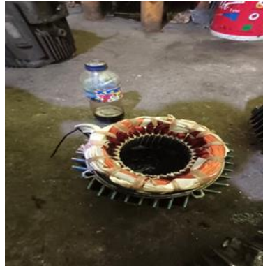
Gambar 3. 65 menuang serlak/ pengeras.
