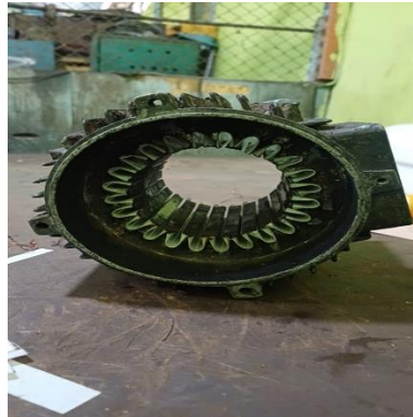
Gambar 3. 33 Pemasangan kertas pelindung email drad/ kertas nemox.
