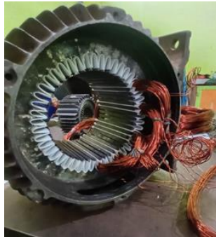
Gambar 3. 26 Pemasangan email drad pada stator.
