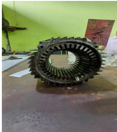
Gambar 3. 35 Pemasangan kertas pelindung email drad/ kertas nemox..
