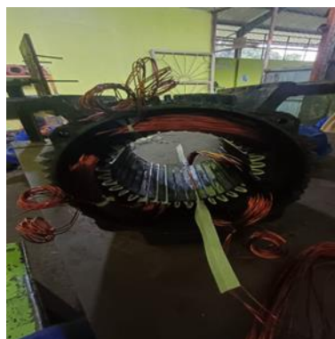
Gambar 3. 63 Pemasangan email drad
