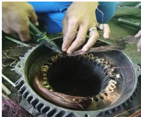
Gambar 3. 80 pembongkaran email drad (sumber:dokumentasi di PTPN IV sei buatan 2025)
