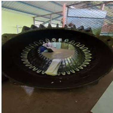
Gambar 3. 75 Pemasangan kertas pelindung email drad
