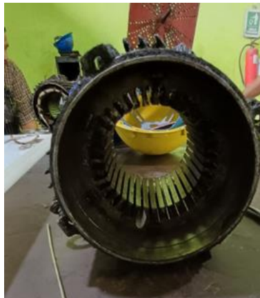
Gambar 3. 25 Pemasangan kertas pelapis email drad/kertas nemox
