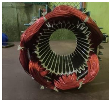
Gambar 3. 82 Pemasangan email drad
