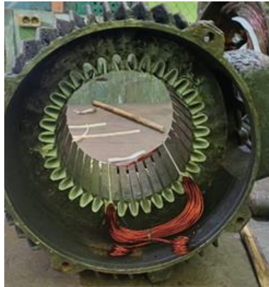
Gambar 3. 31 Pemasangan email drad.
