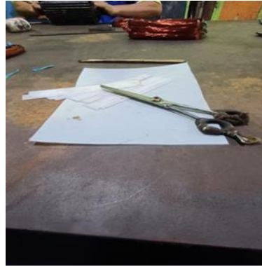
Gambar 3. 68 Pembuatan kertas pelindung email drad
