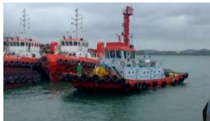
Gambar 2. 12 Tugboat sebagai kapal pendorong kapal tongkang
