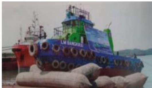
Gambar 2.7 Docking tugboat menggunakan ballon dock
