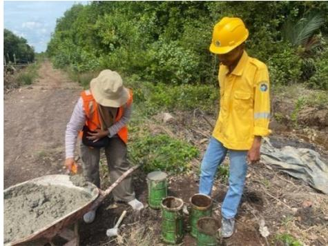
**Gambar 4. 8** Pengambilan Sampel Silinder
