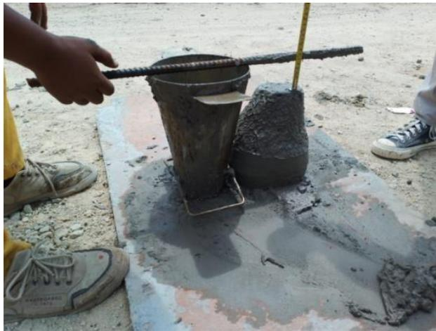
**Gambar 4. 7** Pengujian Slump
