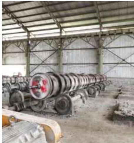
gambar 3.29 Pemadatan dengan spinning/ di putar
