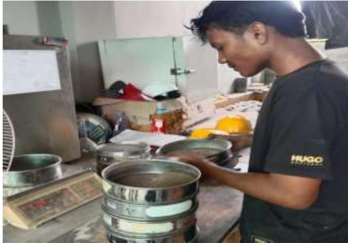
gambar 3.9 Pengujian Analisa saringan agregat halus metode di guncang
