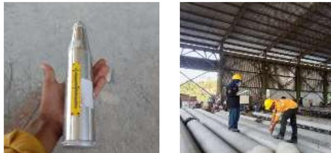
gambar 3.16 pengujian hamner test
