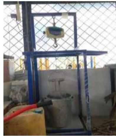
*gambar 3.14 Pengujian spesifik gravity (a). Meringkan permukaan sampel, (b). Alat pengujian spesifik gravity*
