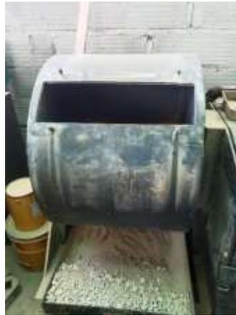
gambar 3.15 pengujian abrasi agregat kasar
