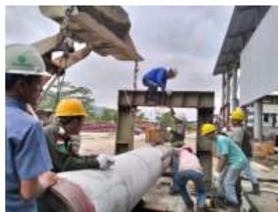
*gambar 3.19 pengujian bending spun pile*
