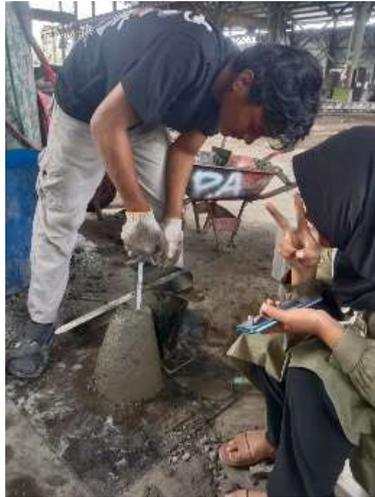
gambar 3.21 uji slump
