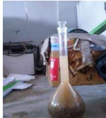
gambar 3 12 Pengujian spesifik gravity agregat halus
