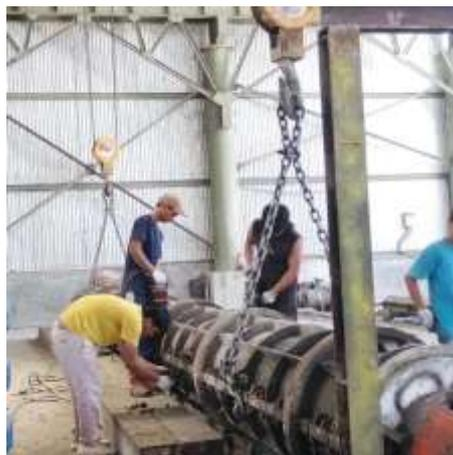
gambar 3.28 Pemasangan baut moulding
