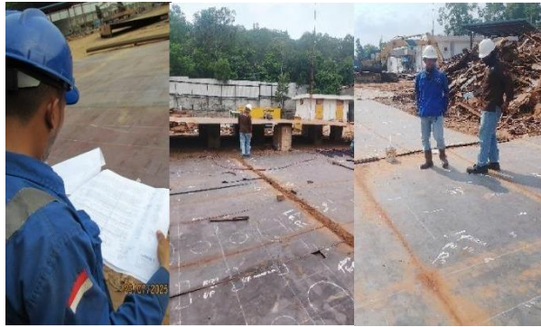
Gambar 3.14 marking plat sesuai gambar
