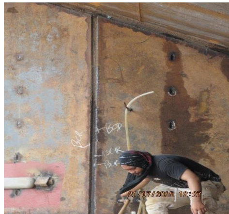
Gambar 3.8 Melakukan pengujian air test
