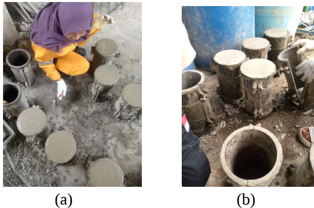
(a) meratakan beton, (b) membuka sampel Gambar 3.24 (a) meratakan beton, (b) membuka sampel Sumber: dokumentasi kerja praktek PT. Kj 2025
