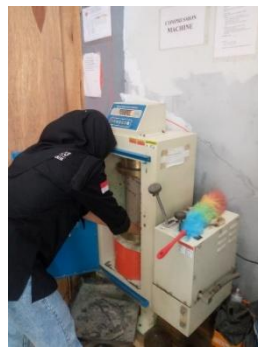
Gambar 3.34 Pengujian kuat tekan silinder
