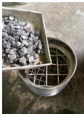
Gambar 3.3 Pengujian Analisa saringan agregat kasar
