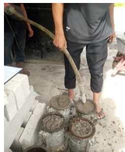
Gambar 3.20 mengisi cetakan dengan beton Sumber: dokumentasi kerja praktek PT. Kj 2025
