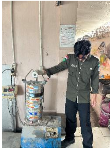
Gambar 3. 1 Pengujian Analisa saringan agregat
