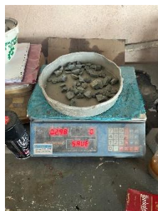
Gambar 3. 3 Pengujian kadar lumpur pada agregat kasar
