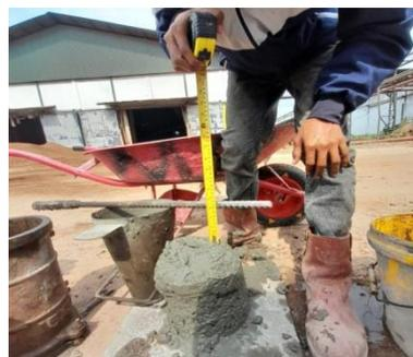
Gambar 3.48 Pengujian slump pada beton
