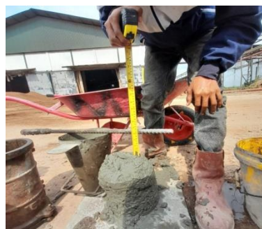
Gambar 3.48 Pengujian slump pada beton ( Sumber : Dokumentasi lapangan 2024 )
