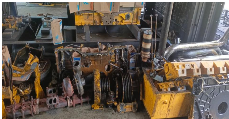
Gambar 3. 68 Pembongkaran part mesin unit 6 secara menyeluruh
