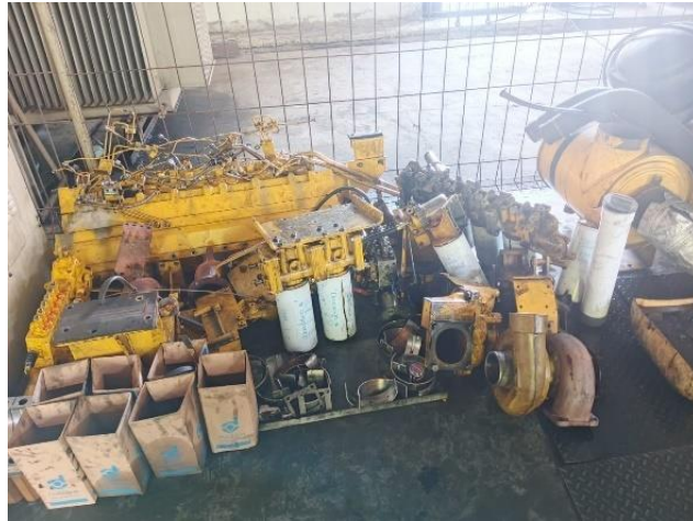
Gambar 3. 66 Pembongkaran mesin unit 5
