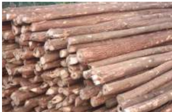
Gambar 3. 23 Kayu cerucuk Sumber: dokumentasi Kerja Praktek
