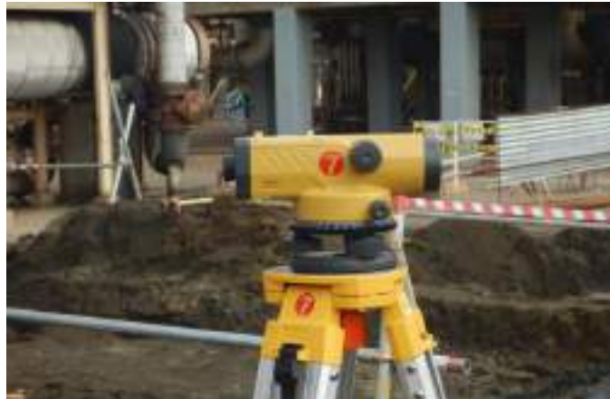
Gambar 3. 5 Waterpass Sumber: dokumentasi Kerja Praktek
