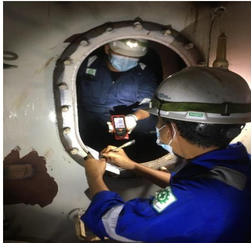
Gambar 3. 59 Kalibrasi Tanki Sumber : Penulis
