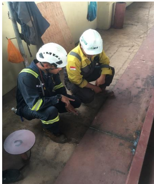
Gambar 3. 36 Visual Welding Inspection Sumber: Penulis
