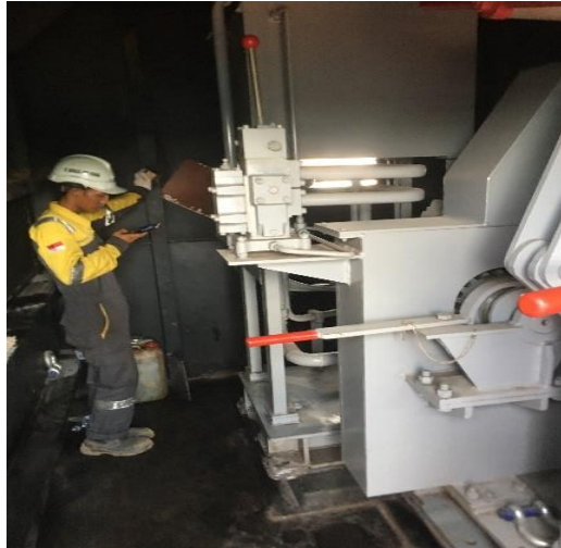
Gambar 3. 23 Pengetesan Windlass Sumber: Penulis
