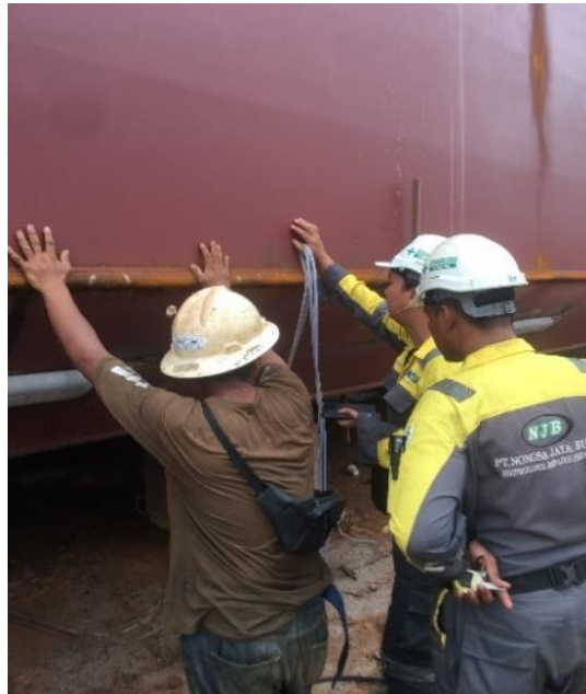
Gambar 3. 3 Proses Draft Marking Sumber: Penulis
