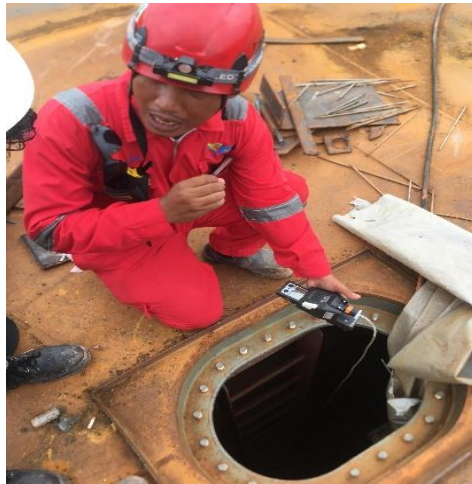
Gambar 4. 3 Menasukan Selang Gas Detector
