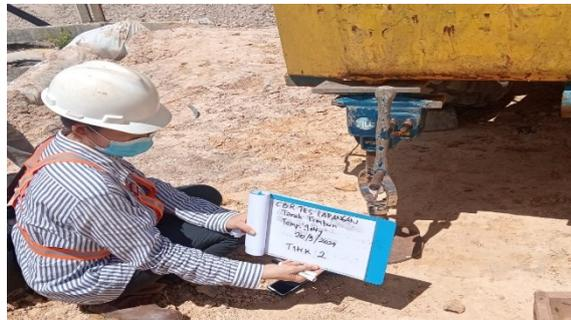
**Gambar 3. 28** Pengujian CBR
