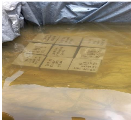
Gambar 3. 27 Sampel Untuk Pengujian Kuat Tekan Beton
