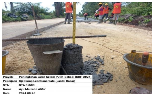
Gambar 3. 26 Pengujian Slump Test Sumber: Dokumentasi Lapangan 2024
