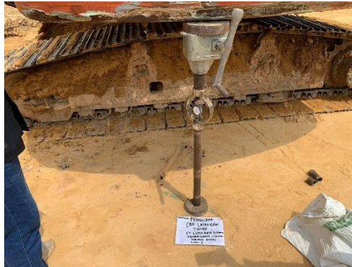
Gambar 3. 5 Pengujian CBR timbunan tanah
