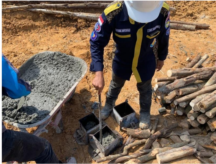
Gambar 3. 81 Pembuatan sampel uji beton
