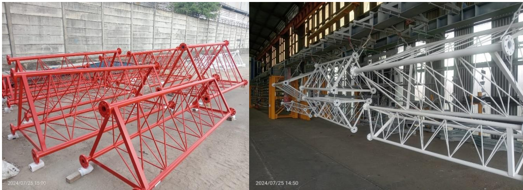
Gambar 3.10 Tower yang sudah dicat (Sumber: Dokumentasi Lapangan, 2024)
