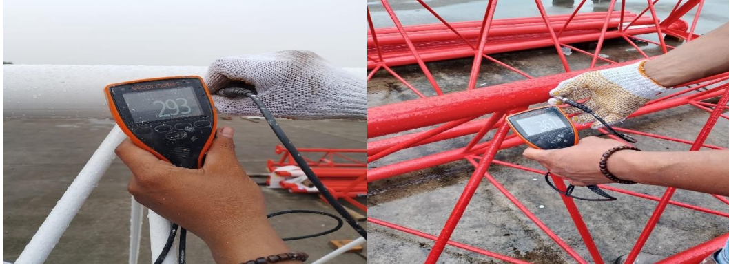
Gambar 3.11 Pemeriksaan visual Coating. (Sumber: Dokumentasi Lapangan, 2024)
