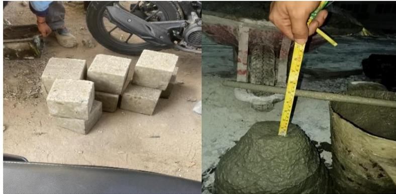
Gambar 3. 17 Pembuatan Sampel Pegujian Dan Uji Slump
