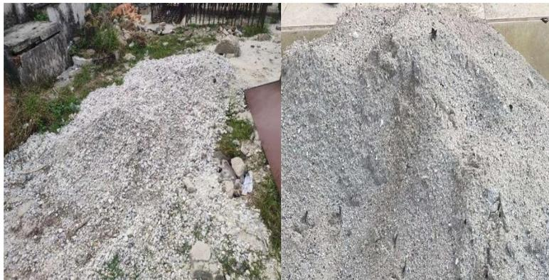
Gambar 2 5 Agregat Kasar Dan Agregat Halus
