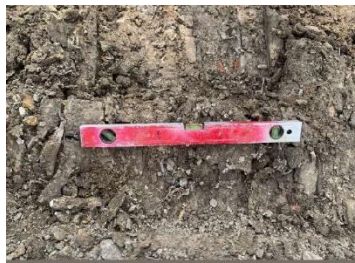
Gambar 2 22 Waterpass (Sumber : dokumentasi Lapangan 2024)
