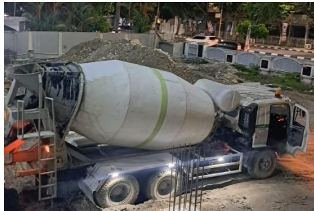
Gambar 2 11 Truck Mixer (Sumber : dokumentasi Lapangan 2024)
