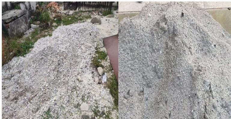
Gambar 2 5 Agregat Kasar Dan Agregat Halus (Sumber : dokumentasi Lapangan 2024)
