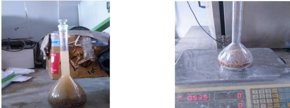
Gambar 3. 11 Pengujian spesifik gravity agregat halus
