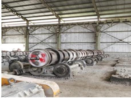
Gambar 3. 27 Pemadatan dengan *spinning*/ di putar
