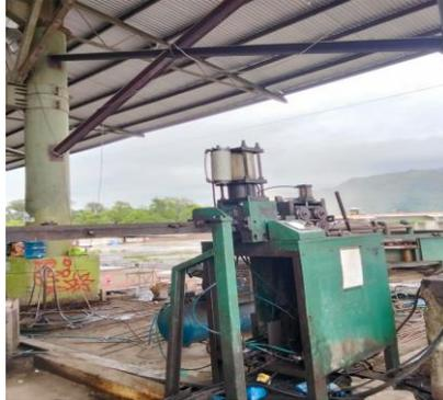
Gambar 3. 21 Mesin pemotong tulangan pokok
