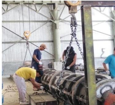
Gambar 3. 26 Pemasangan baut *moulding*
