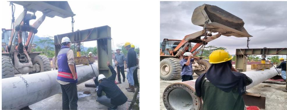
Gambar 3. 17 Pengujian bending spun pile
