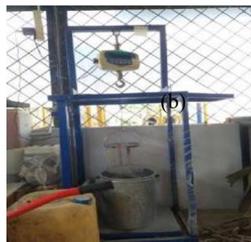
(b). Alat pengujian spesifik *gravity*
