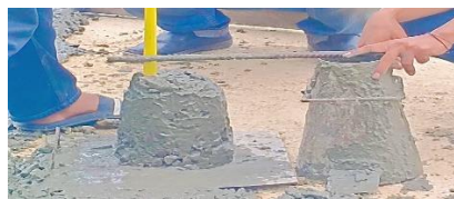
GAMBAR 3. 22 Slump test (Sumber) : Dokumen Lapangan, 2024
