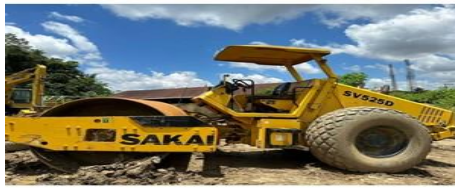
GAMBAR 4. 3 Vibro Roller (Sumber) : Dokumen Lapangan, 2024
