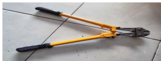
GAMBAR 3. 8Gnting Besi (Sumber) : Dokumen Lapangan , 2024
