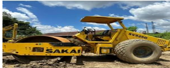
GAMBAR 3. 4Vibro Roller (Sumber) : Dokumen Lapangan, 2024
