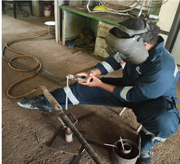
Gambar 3.2 Pengelasan pipa
