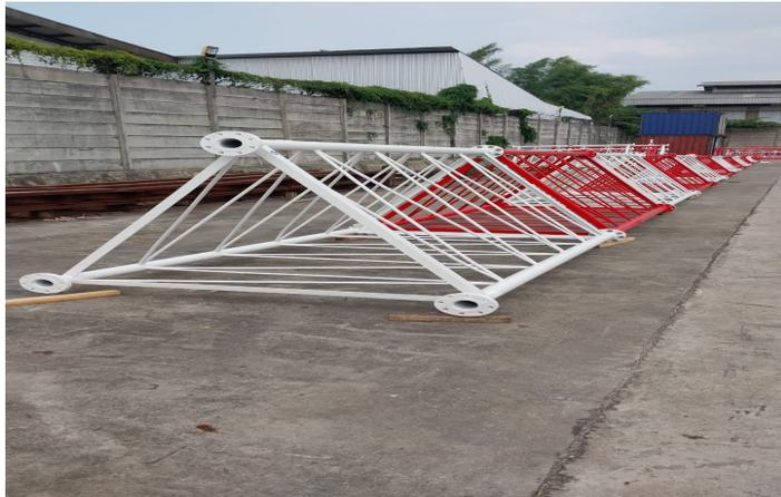
Gambar 3.8 Dilakukan trial assemblyng ulang
