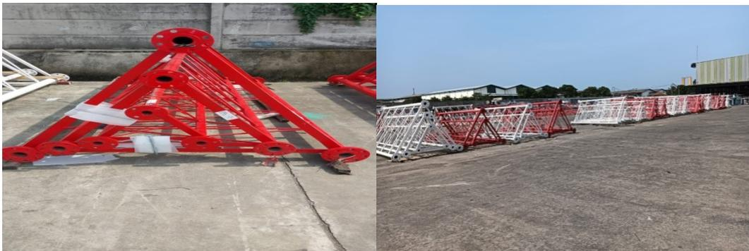
Gambar 3.12 Material Tower sudah dipacking
