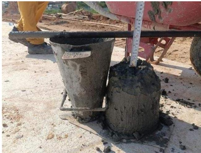
Gambar 3.63 Slump Test
