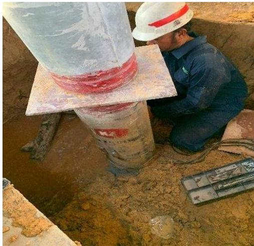
Gambar 3.45 PDA test
