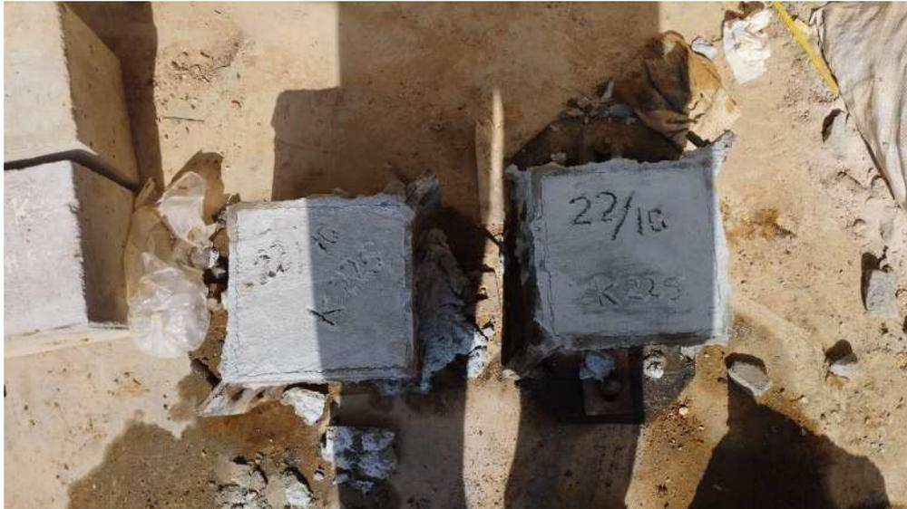
Gambar 3.116 Pembuatan sampel kubus
