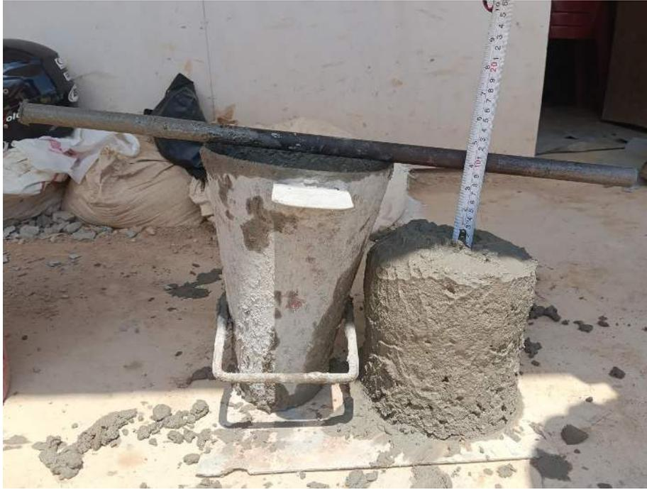
Gambar 3.115 Slump rigid beton lintasan atletik
