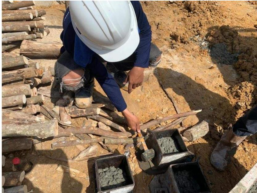
Gambar 3.130 Pembuatan sampel kubus
