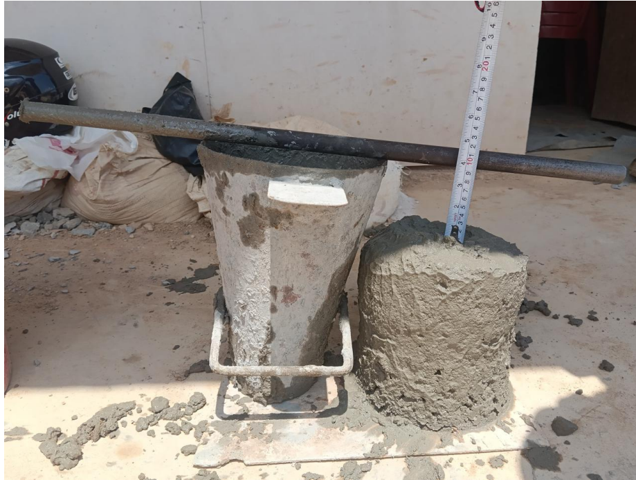
Gambar 3.115 Slump rigid beton lintasan atletik (Sumber: Dokumentasi Pribadi)
