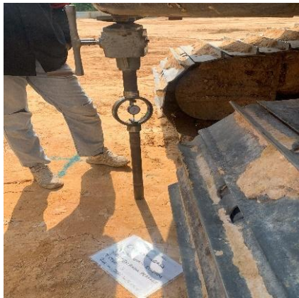
Gambar 3.4 Uji CBR Lapangan (Sumber: Dokumentasi Lapangan, 2024)
