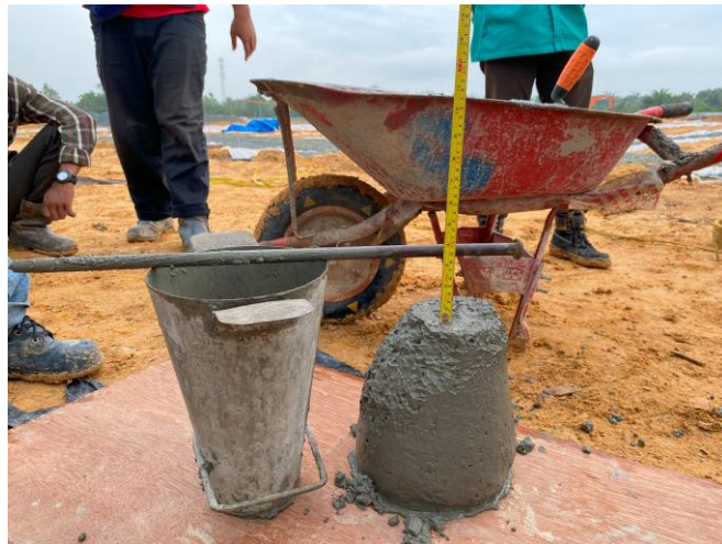
Gambar 3.54 Slump Test (Sumber: Dokumentasi Lapangan, 2024)
