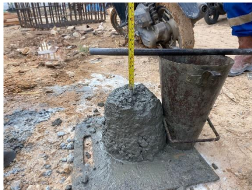
Gambar 3.32 Slump Test (Sumber: Dokumentasi Lapangan, 2024)
