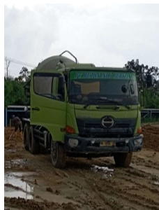
Gambar 3. 90 Truk mixer (Sumber: Dokumentasi Kerja Praktek, 2024)
