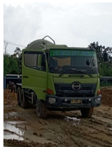
Gambar 3. 66 Truk mixer (Sumber: Dokumentasi Kerja Praktek, 2024)
