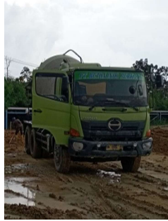
Gambar 3. 112 Truk mixer (Sumber: Dokumentasi Kerja Praktek, 2024)
