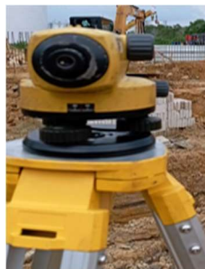
Gambar 3. 17 Waterpass (Sumber: Dokumentasi Kerja Praktek, 2024)
