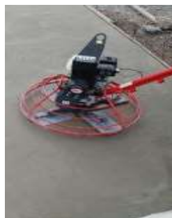
Gambar 3. 114 Trowel beton (Sumber: Dokumentasi Kerja Praktek, 2024)
