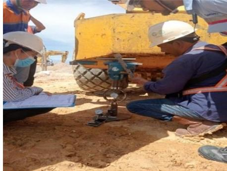
Gambar 3.28 Pengujian Tes CBR
