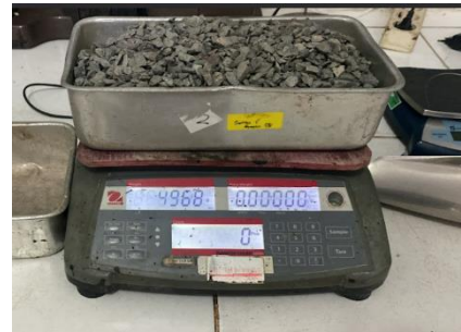
Menimbang benda uji setelah di oven
