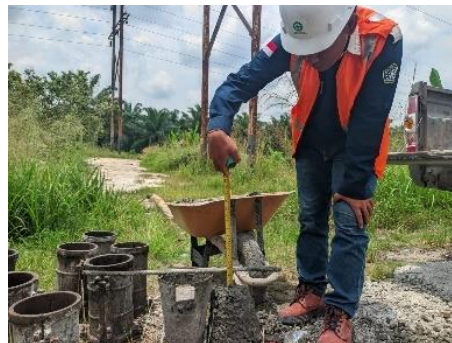
Gambar 3. 47 Slump Test Beton FS 45 (Sumber Dokumentasi Lapangan 2025)
