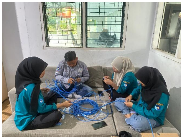
Gambar 3. 3 Perakitan Kabel Jaringan Untuk CCTV dan IP Phone
