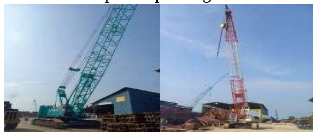
Gambar 2.10. Crawler Crane kapasitas 260 ton
