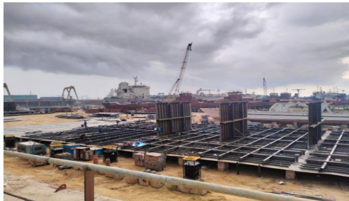
Gambar 3.6 Sekat-sekat pada Tongkang
