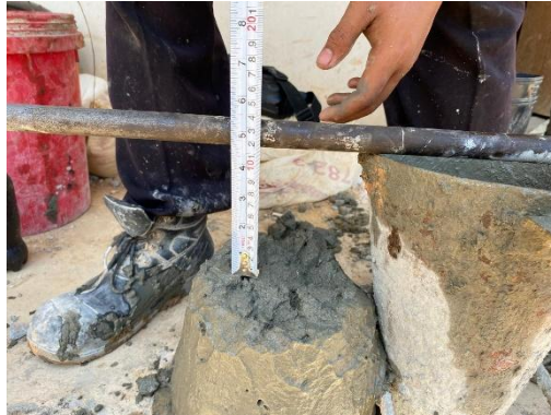
Gambar 3. 52. Pengujian slump beton sloof (Sumber : Dokumentasi Pribadi, 2024)
