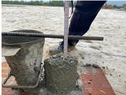
Gambar 3. 56 . Pengujian slump beton (Sumber : Dokumen Pribadi, 2024)
