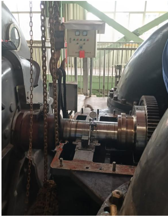
Gambar 3. 6 Melepas lower half bearing Sumber: dokumentasi pribadi
