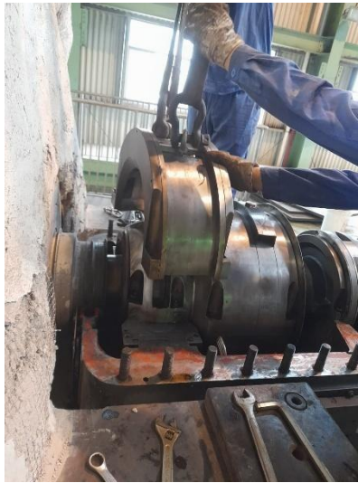
Gambar 3. 9 Pemasangan upper half bearing Sumber: dokumentasi pribadi
