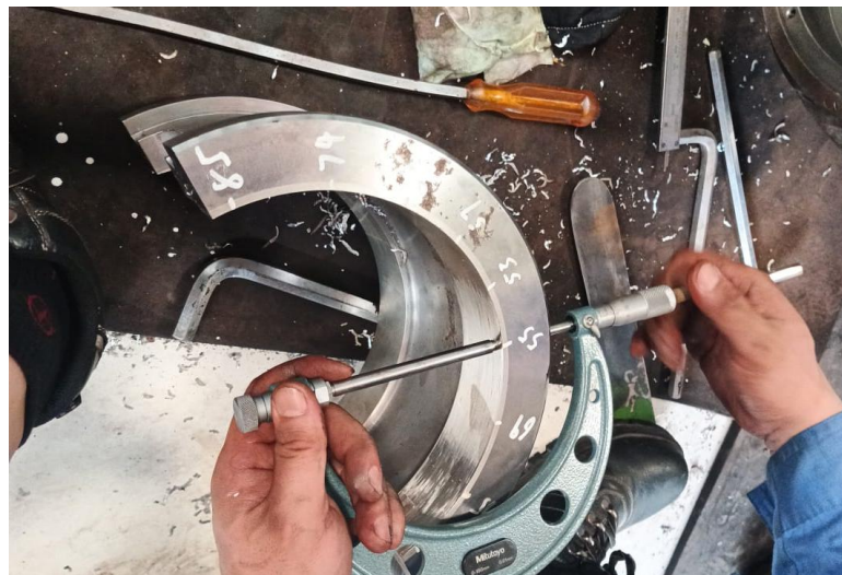
Gambar 3. 7 Proses scraping dan pengukuran pada journal bearing Sumber: dokumentasi pribadi
