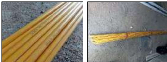
Gambar 3.104 Pipa kabel kuning 5/8" (Sumber : Dokumentasi KP, 2025)
