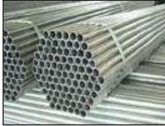
Gambar 3.131 Besi galvanis 6 inch (Sumber : Dokumentasi KP, 2025)
