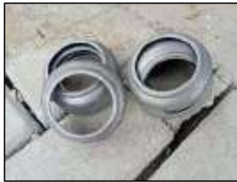
Gambar 3.132 Penutup hand railing besi galvanis (Sumber : Dokumentasi KP, 2025)
