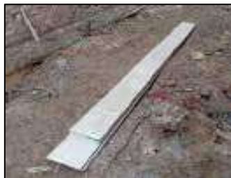
Gambar 3.85 Listplank GRC (Sumber : Dokumentasi KP, 2025)
