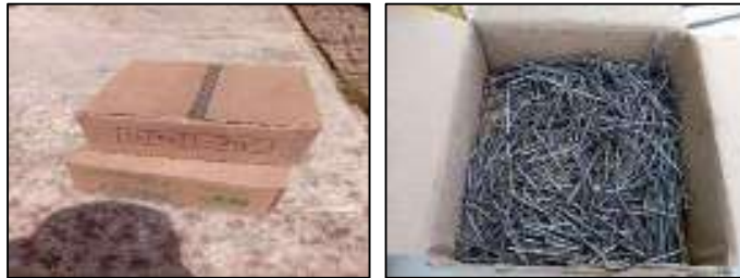
Gambar 3.71 Paku diameter 3", 2,5", 2", 1,5", 1", 0,5" (Sumber : Dokumentasi KP, 2025)
