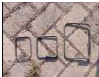
Gambar 3.77 Tulangan begel (Sumber : Dokumentasi KP, 2025)
