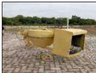
Gambar 3.27 Molen Listrik Kapasitas 50 kg (Sumber : Dokumentasi KP, 2025)
