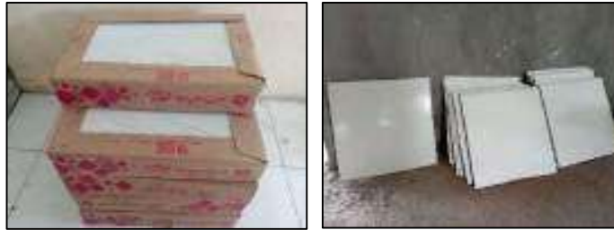
Gambar 3.110 Keramik lantai 25x40 (Sumber : Dokumentasi KP, 2025)
