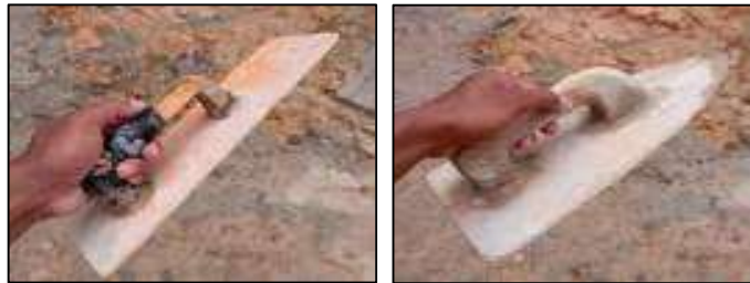
Gambar 3.23 Raskam biasa dan raskam kayu (Sumber : Dokumentasi KP,2025)
