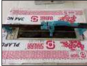
Gambar 3.47 Tile cutter (Sumber : Dokumentasi KP,2025)
