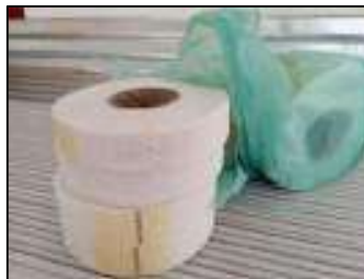
Gambar 3.91 Lakban plafond gypsum (Sumber : Dokumentasi KP, 2025)
