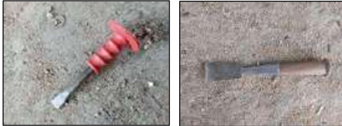
Gambar 3.35 Pahat manual (Sumber : Dokumentasi KP,2025)
