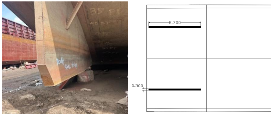
Gambar 1.2 skeg kapal Tongkang
