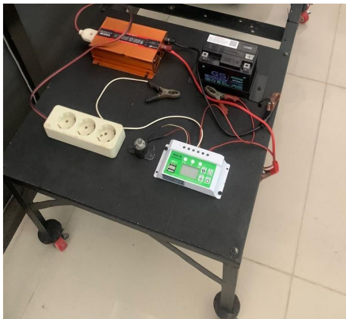
Gambar 4.2 Hasil Perancangan Sistem Kelistrikan dan Penyimpanan Energi Sumber: (Dokumentasi, 2026)
