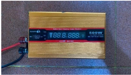
Gambar 3.8 Inverter Sumber: (Dokumentasi, 2026)
