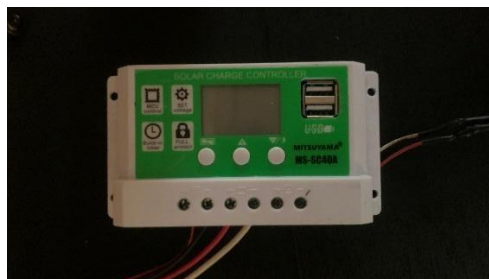
Gambar 3.6 Solar Charge Control Sumber: (Dokumentasi, 2026)
