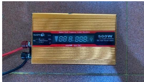
Gambar 2.4 Inverter Sumber: (Dokumentasi,2026)
