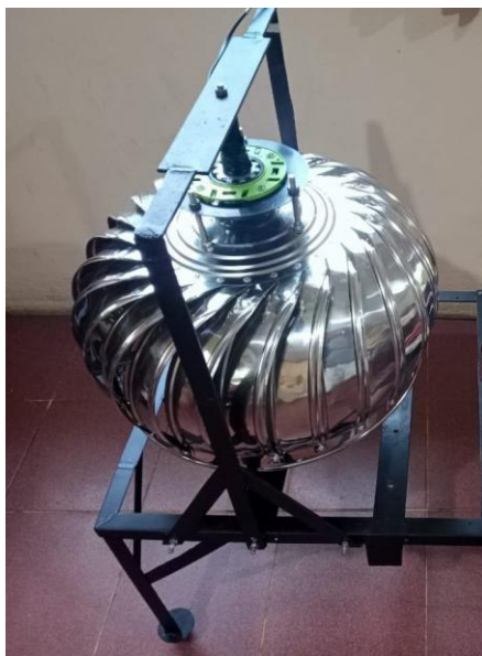
Gambar 4.1 Hasil perancangan Turbin Ventilator dengan Generator Sumber: (Dokumentasi, 2026)
