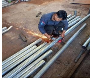
Gambar 3. 52 Pemotongan tiang pipa galavis 3inch Sumber: Pribadi
