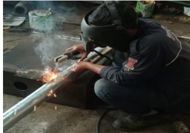
Gambar 3. 49 Pengelasan tiang utama Sumber: Pribadi
