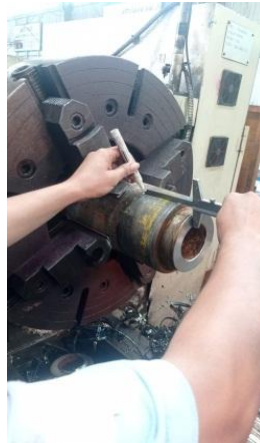
Gambar 4 6 pengukuran menggunakan depth caliper Sumber : Dokumentasi
