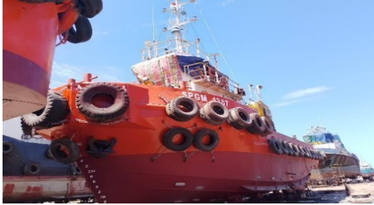
Gambar 4.68 hasil pekerjaan pemasangan ban dapra baru tampak depan
