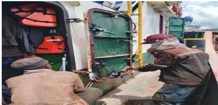
Gambar 4.13 Proses Pelancaran Togel Pintu Masuk Engine Room
