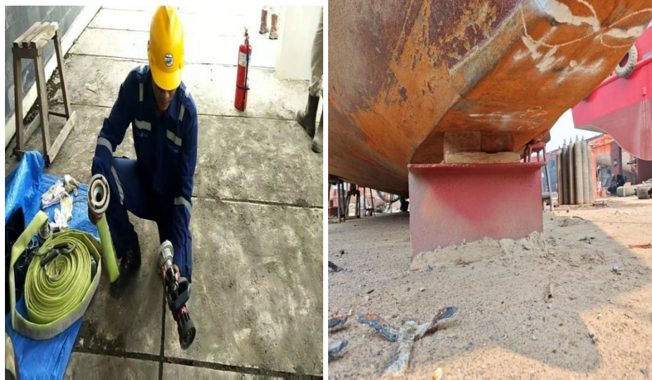
Gambar 4.44 Persiapan Area Kerja Sebelum Proses Replating
