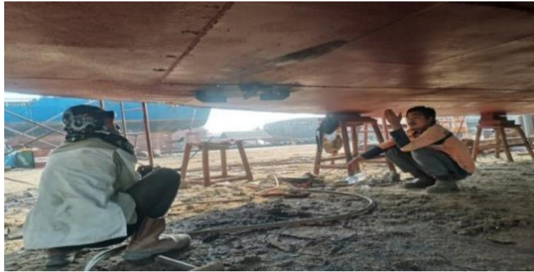
Gambar 4.22 Proses Penyetelan Pelat Bottom Kanan Tengah
