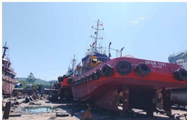
Gambar 4.67 Hasil Pekerjaan Pemasangan Ban Dapra Baru Tampak Belakang
