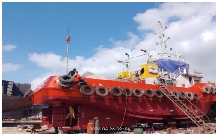
Gambar 4.26 Proses Fit Up (Pemasangan) Ban Dapra
