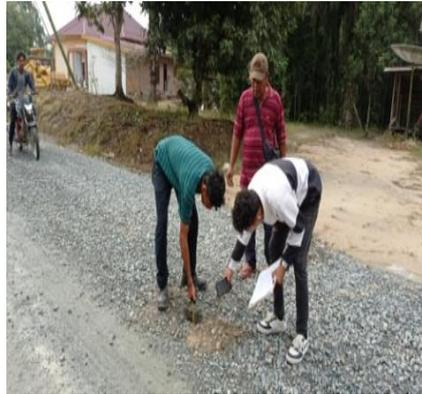
( Gambar 3. 27 Pengujian Test Pit Base A)
