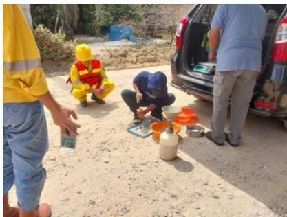
(Gambar 3. 24 Pengujian Sand Cone)
