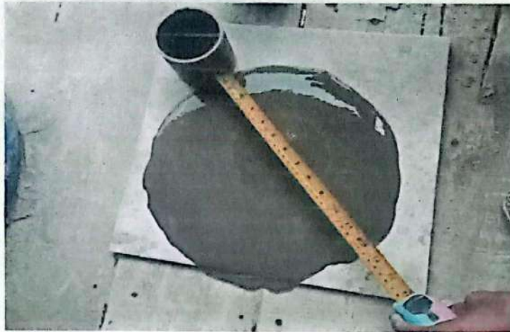
Pengujian Flow mortar Syarat ketentuan flow mortar 30 cm.
