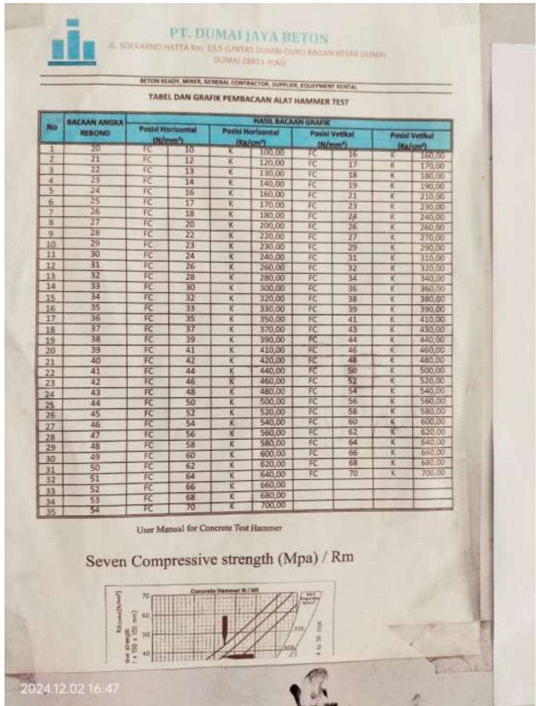
Gambar 2. 2 Grafik pembacaan alat hammer test
