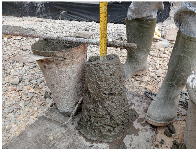
Gambar 4.3 (Hasil Pengujian Slump)
